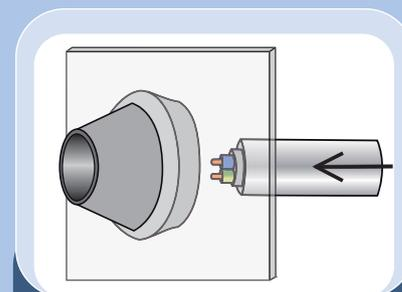
Elastische Dichtlippen für Wandstärken von 1 bis 4 mm.
