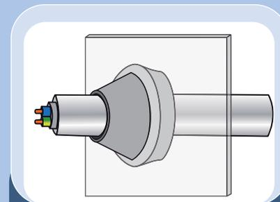
Der flexible Innendurchmesser ist für verschiedene Kabelstärken geeignet.
