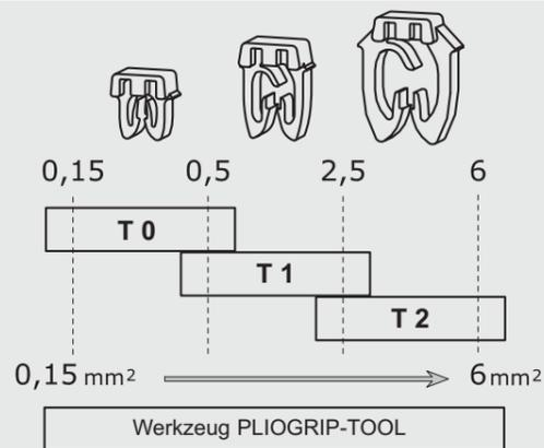
Drei Typen von Markierern, die Querschnitte von 0,15 bis 6 mm<sup>2</sup> abdecken.
